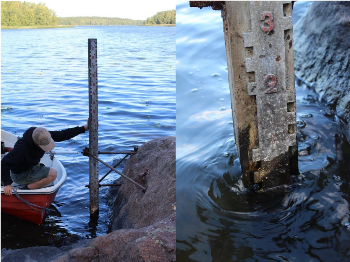
Kuva 12. Ahmasveden Nirunperällä Nopperon tilan saunanrannassa sijaitseva vedenkorkeusasteikko (vasen kuva) ja lähikuva vedenkorkeusasteikosta 7.8.2018 (oikea kuva).
